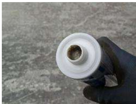
排出口（エア抜き後）
