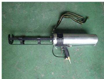
写真 2-9 500、1200 共用エアガン
